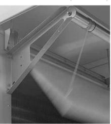
Mit der Güntner Abtauklappe, montiert am Lufteintritt der Baureihen GHN, GGHN, AGHN, GHS, CXGHN und CPGHN verbessern Sie den Abtauwirkungsgrad Ihrer Kälteanlage. Die Klappe ist während der Abtauung geschlossen. Dadurch wird freie Konvektion im Luftkühler, Dampfaustritt im Lufteintritt und die daraus entstehende Eisdeckenbildung verhindert. Steuerung der Abtauklappe siehe Betriebsanleitung.
