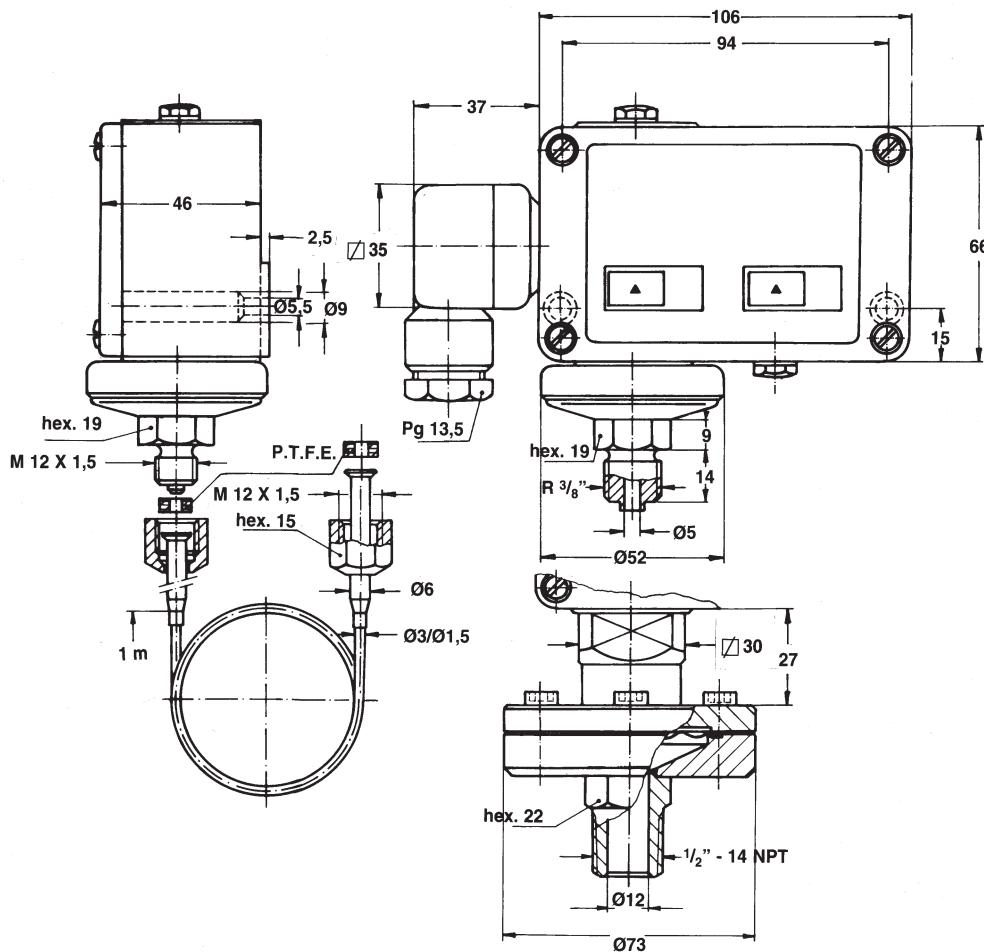
Čelni pogled prikazuje primer za direktno vgradnjo (standardni osnovni priključek je R3/8"), na stranskem pogledu pa je prikazana daljinska izvedba priključitve, ko je presostat z osnovnim priključkom M 12 x 1,5 pritrjen na steno ali nosilec. Vgradne mere za ta primer so na risbi prikazane črtkano.
