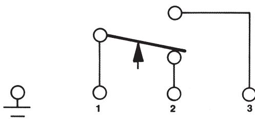
Tokokrog 1 – 3 se sklene pri povečanju tlaka. Nastavljena vrednost na skali ustreza zgornji točki naraščajočega tlaka. Točka preklopa je pri padajočem tlaku za poljubno nastavljeno preklopno diferenco (3 do 30% območja) nižja od nastavljene vrednosti.
