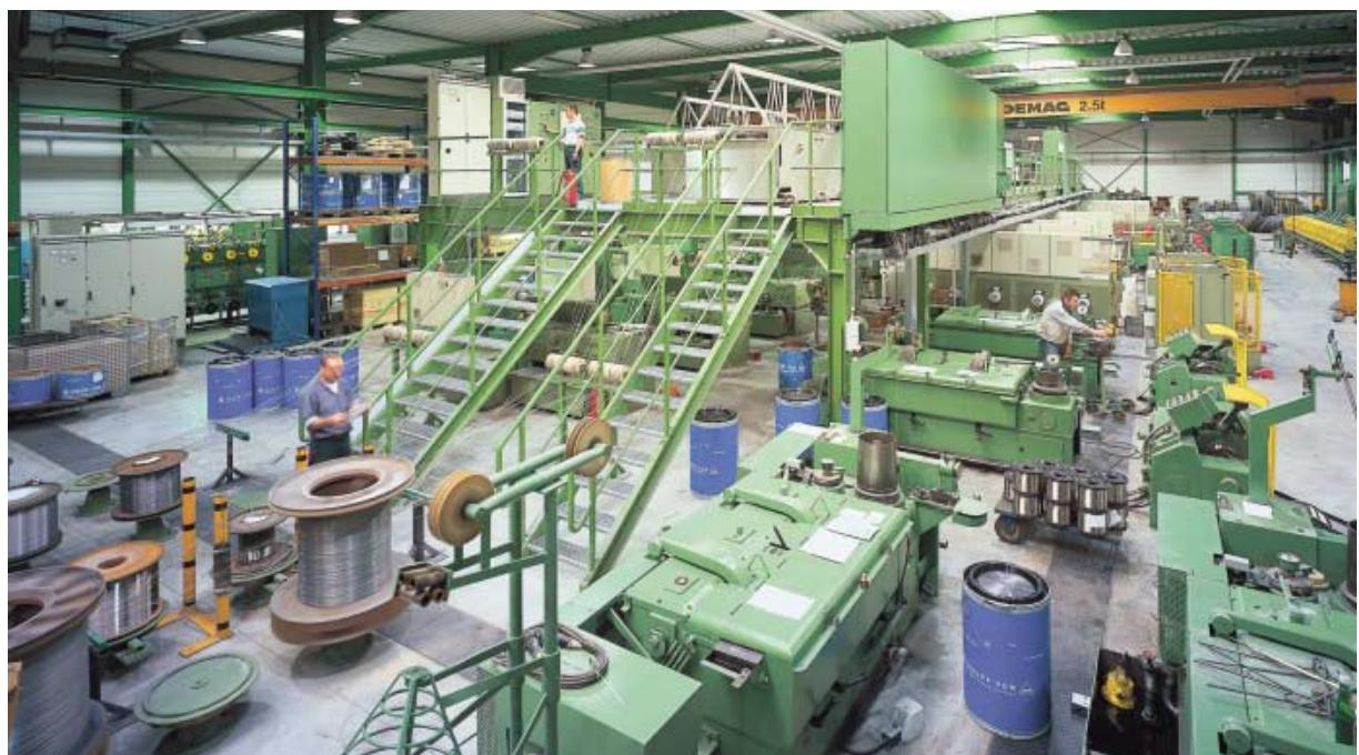
Blick in den Linienzug. Oben wird der Draht gereinigt, ge-glüht und beschich-tet. Ohne Unter-brechung läuft er eine Etage tiefer und wird hier konti-nuierlich verteilt – entweder in den Trocken- oder in den Nasszug.
