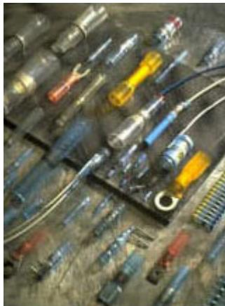
Sastoje se od transparentne toploskupljajuće cijevi i lemnog prstena montiranog unutar cijevi. Zagrijavanjem pomoću toplog zraka lemn se prsten topi oko žica, a toploskupljajuća cijev se steže. Na taj način jednom radnom operacijom postižemo 3, a to su:
