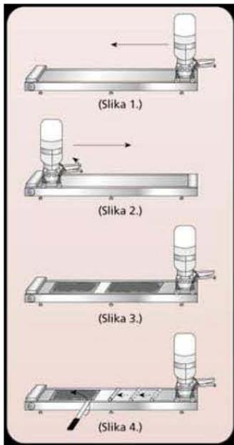
Masa iz spremnika za tijesto kroz dozer curi u kolicu koja se iz nultog položaja dovodimo do početka radne ploče na lijevu stranu. (Slika 1.)
