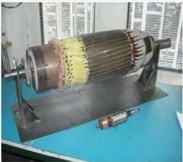
7. Reparacija na rotori od DC motor do 20 KW:
