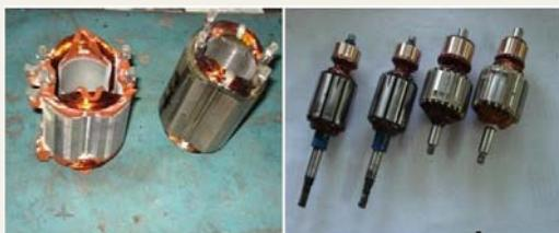
4. Izrabitka na mali serii na rotori i statori kako i mali el. motori po naracka: Vo moznost sme da izrabituvame mali serii na rotori i statori. Raspolagame so linija za kvalitetna izrabitka i zapazuvanje na potrebnite tehnoloski normi.
