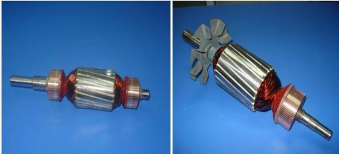
6. Reparacija na rotori od kolektorskite el. motori: Raspolagame so linija za kvalitetna reparacija, kako i izrbotka na mali serii od aspekt na: masinsko namotuvanje, rotaciono lakiranje(impregnacija) so pecenje, dijamantska obrabotka na kolektorot, balansiranje so odzemanje na materjal.
