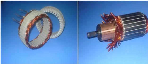
9. Reparacija na rotori i statori od avto elektrika:
