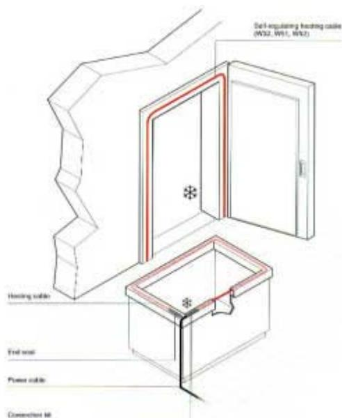
Grijanje podova u hladnjacima vrši se zbog sprečavanja smrzavanja tla ispod gazne površine. Zbog velike razlike u temp. tla i temp. u rashladnoj komori (do -25oC) dolazi do smrzavanja tla, u koji kapilarno prodire voda, i pucanja podova – gazne površine.
